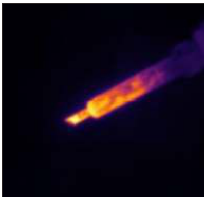
烙铁温度点检
